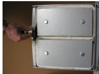
Fot.9. Wymiana uszczelki ceramicznej drzwiczek
