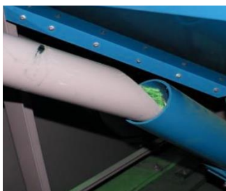
Fot.2. Wyciąganie rury podajnika ze ślimakiem
