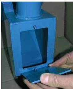
Fot.1. Pokrywa otworu rewizyjnego
